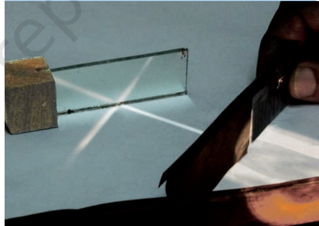
चित्र 13.1 : परावर्तन दर्शाने की व्यवस्था
